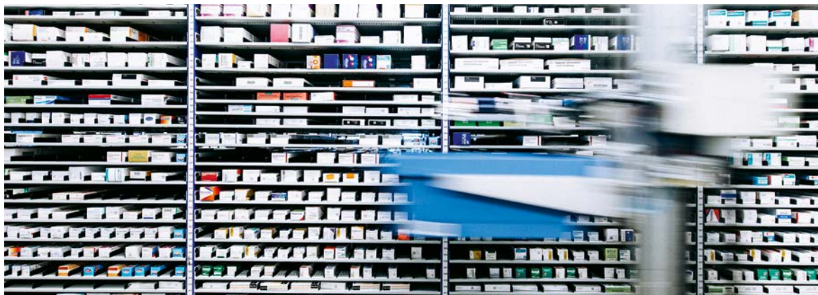
Kommissionierautomat: Die Kiste saust von Regal zu Regal. Sobald sie das benötigte Medikament erreicht hat, stoppt das Band abrupt und die Verpackung purzelt in der gewünschten Stückzahl in die Box.
